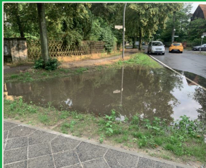
Nach Starkregen planmäßig gefüllte neue Versickerungsmulde am Fürstendamm ©Bürgerverein Frohnau e.V.
